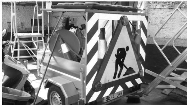
Panel de señalización de trabajos en calzada remolcado por vehículo
