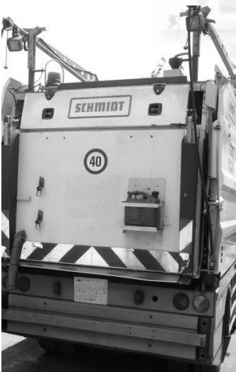
En la parte trasera dispone de un soporte para la colocación de la garrafa de gasolina (con su identificación), pues está terminantemente prohibido que esté en la cabina del conductor. En ciertos modelos existen cajones de grandes dimensiones para el transporte de sopladores.
