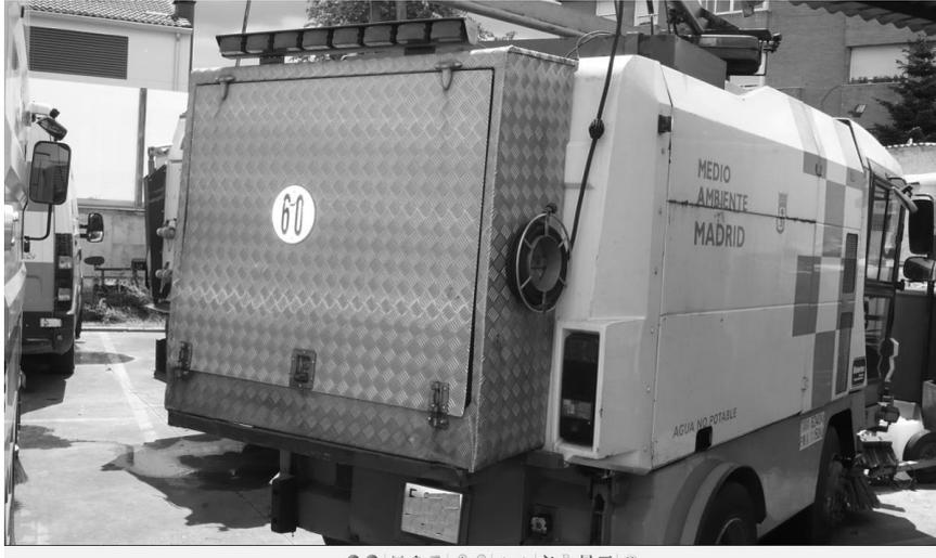
Cajón para guardar los sopladores y las luces de trabajo.
