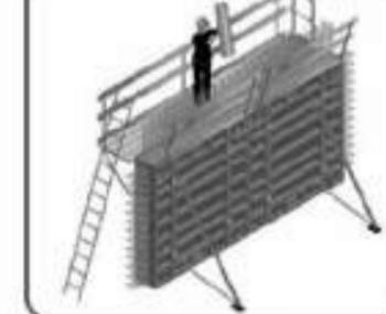
Acceso a la plataforma de trabajo con la ayuda de un medio auxiliar o al propio acceso integral del encofrado y colocación de las barandillas esquinales/laterales y hormigonado.
