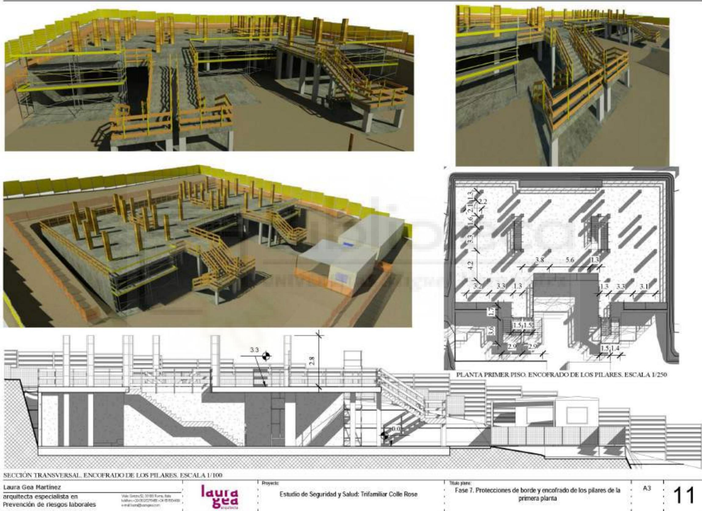
Figura 18. Plano 11, colocación de protecciones de borde de forjado y encofrado de los pilares de la primera planta. Fuente: elaboración propia con aplicación BIM
