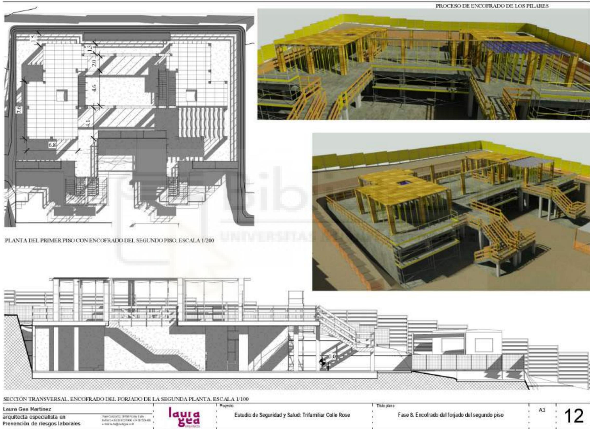
Figura. Plano 19, encofrado del forjado de la segunda planta. Fuente: elaboración propia con aplicación BIM
