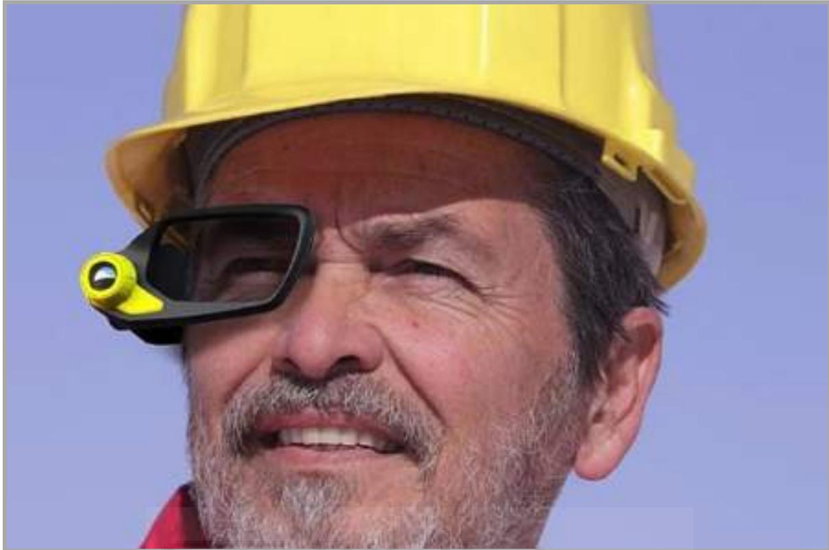
Figura 30. Operario usando gafas de realidad aumentada para ver fases futuras de la obra
