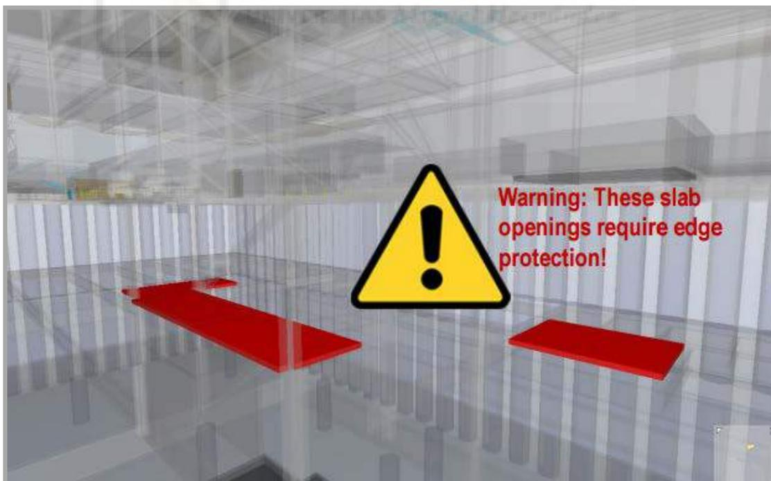
Figura 25. Advertencia después de realizar un escaneado indicando que las aberturas en forjado necesitan de la instalación de una protección de borde.
