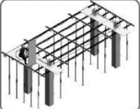
3. A continuación se sube al encofrado con la ayuda de un medio auxiliar normalizado en la zona del pilar con la línea de vida y se amarra al anclaje al bloque retráctil anticaldas y éste a la línea de vida.
