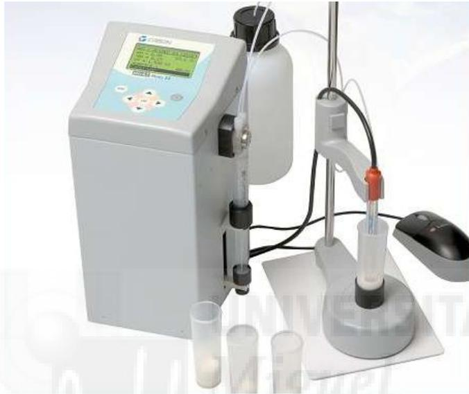
**Figura 8:** pHmetro pHmatic 23 CRISON utilizado para medir la acidez.
