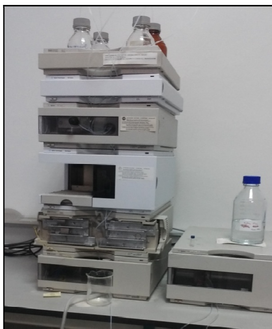
Foto 22. Cromatógrafo de líquidos hplc
