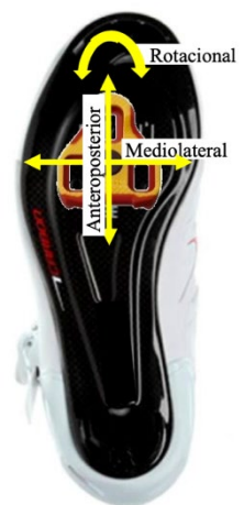
Figura 4 – Ejes de movimiento de la cala sobre la zapatilla de ciclismo.
