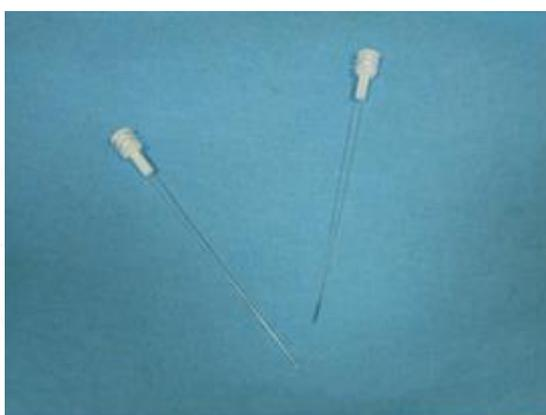
Figura 34. Capilares de 1 mm de diámetro
