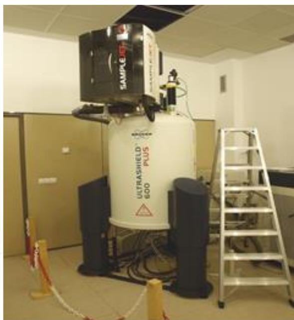
Figura 35. Equipo de RMN Bruker Avance 600MHz equipado con robot SampleJet.
