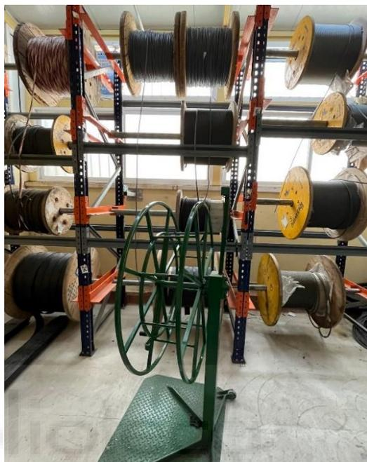
Para recoger de las bobinas el cable metálico y mangueras eléctricas que se necesita y evitar un sobreesfuerzo mayor, se utiliza el enrollacables de la Ilustración 9.
