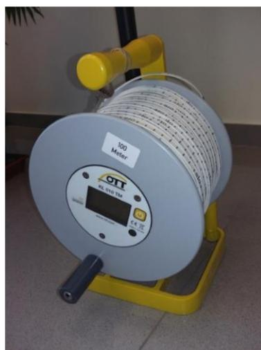
Medidor de nivel piezométrico
