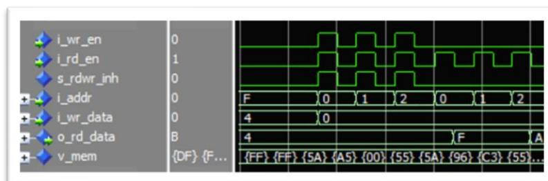
Ilustración Código 59. Formas de onda "PASO 3" RAM SECCED
