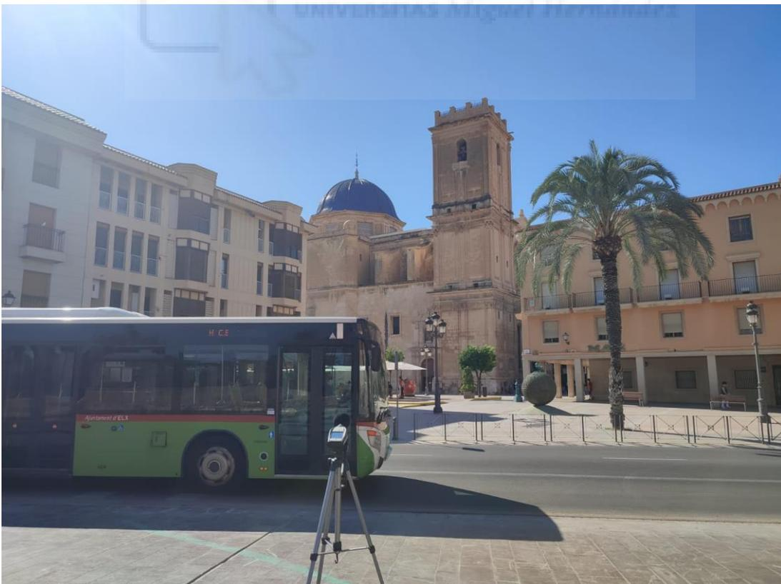
Figura 4: Toma de datos en zona MAHE con sonómetro Integrador tipo 1.
