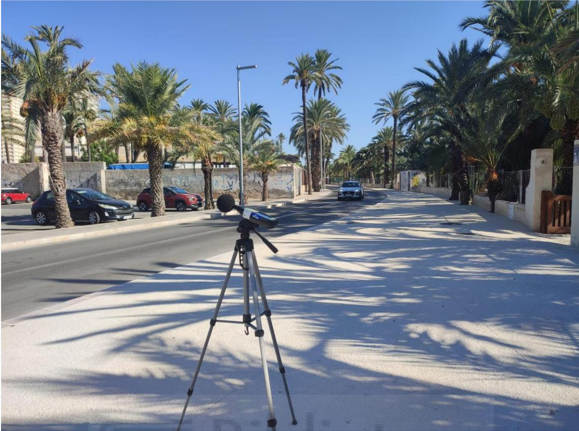
Figura 3: Toma de datos en zona Candalix con sonómetro Integrador tipo 1.
