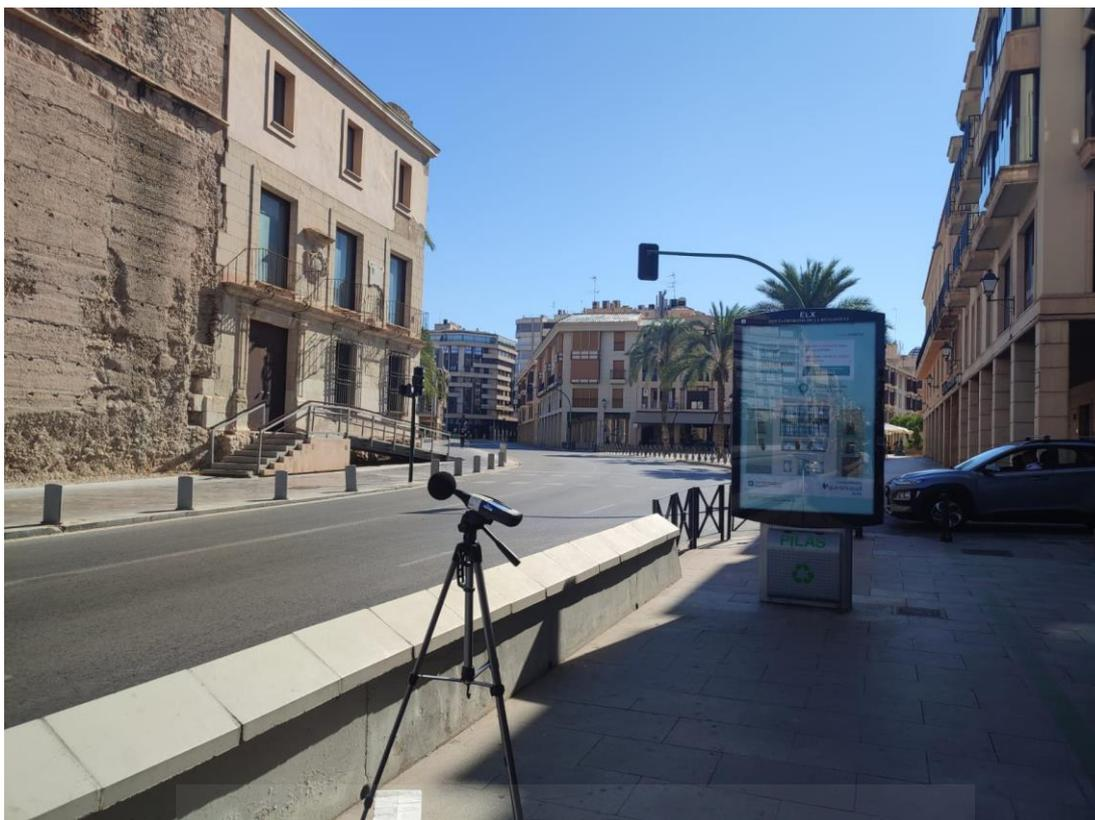
*Figura 5: Toma de datos en zona Diagonal del Palau con sonómetro Integrador tipo 1.*
