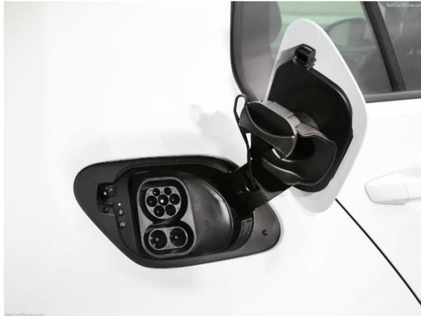
Ilustración 12: Tapa de vehículo con conector CCS Combo 2
