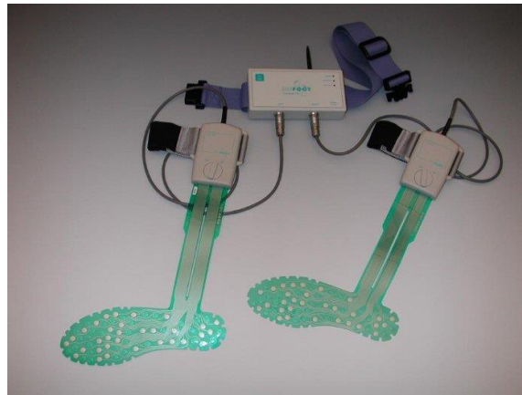
Figura 3. Plantillas instrumentadas, Biofoot IBV®
