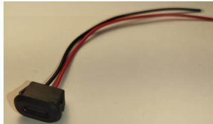
Imagen 20 - Conexión hembra tipo C
