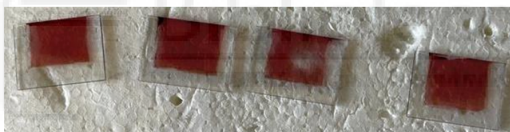
Figura 23 Sustrato Preparado para Metalizar
