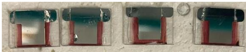
Figura 27 Células Solares Orgánicas Encapsuladas
