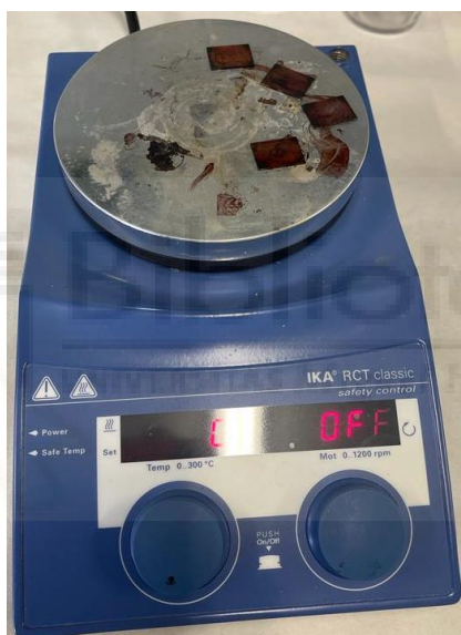
Figura 21 Evaporación del Disolvente Clorobenceno
