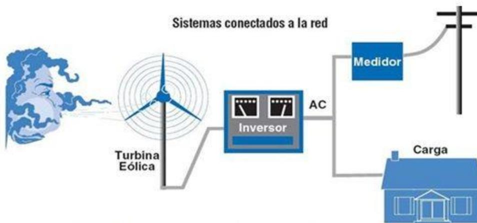
Esquema básico de una instalación eólica doméstica conectada a red
