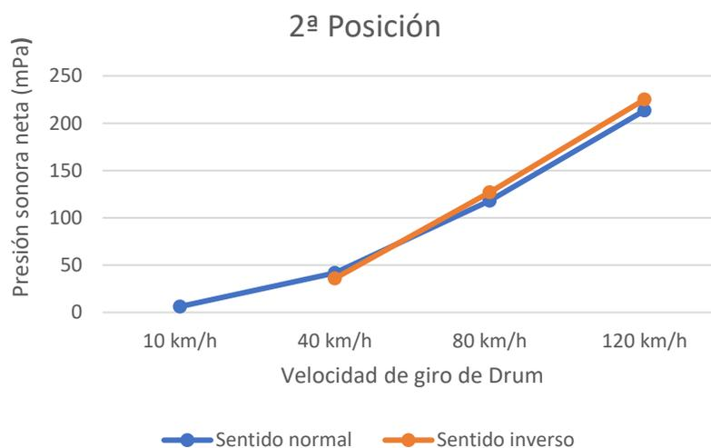
Gráfica 2: Valores netos de presión sonora en a) en dB y b) en milipascales, generada únicamente por el ruido de rodadura con el neumático real a distintas velocidades (2ª posición).
