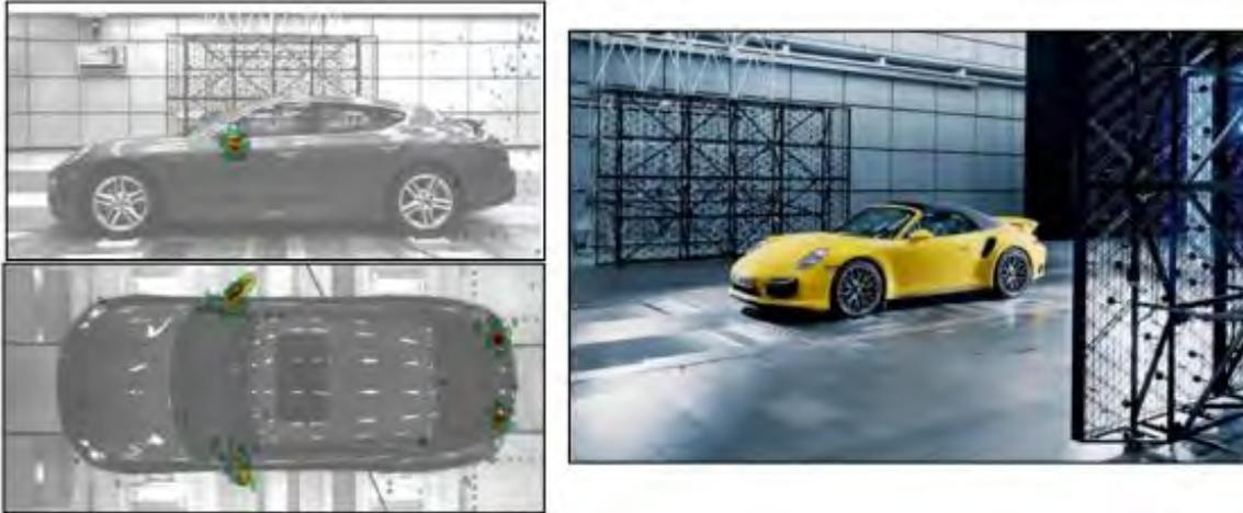
Figura 20: Imágenes del estudio de localización sonora de ruido aerodinámico de vehículos en túnel de viento [17].
