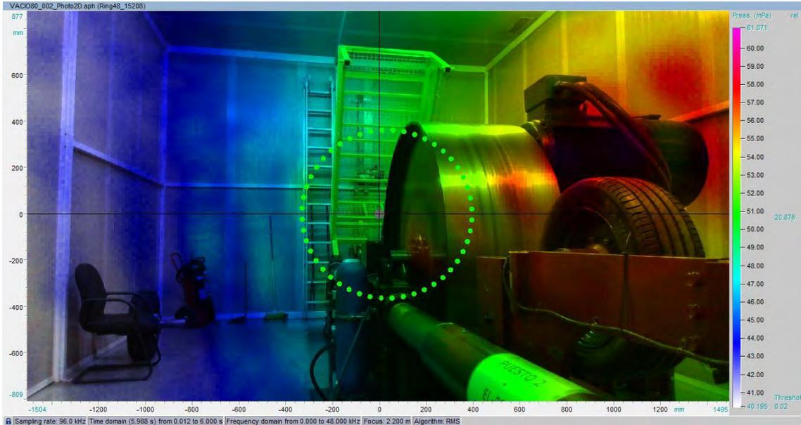
Figura 34: Fotografía 2D de la Acoustic Camera, con el Drum girando a 80 km/h en sentido normal, primera posición y neumático real en vacío .
