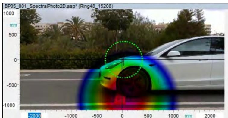
Figura 21: Imagen del Análisis sonoro de la circulación de un vehículo eléctrico sobre resaltos [18].
