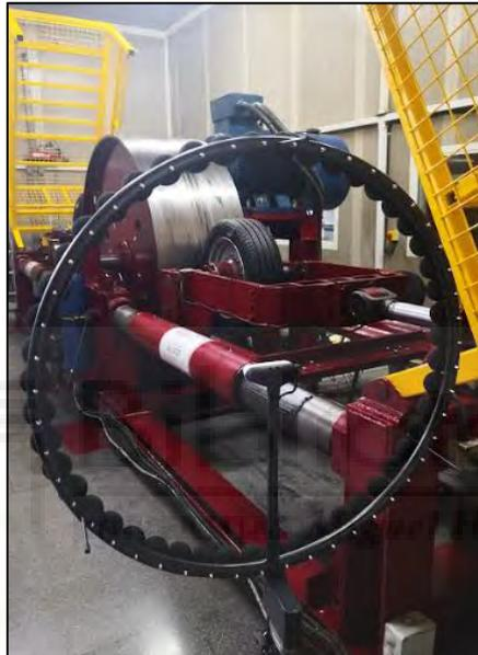
Figura 27: Fotografía de la primera posición del array de micrófonos en el drum.
