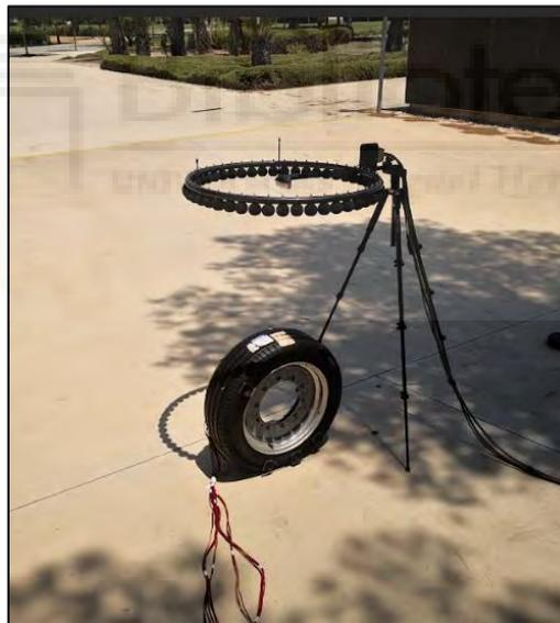
Figura 30: Fotografía de la posición frontal (a), perfil (b) y superior (c) del array de micrófonos sobre una superficie plana reflectante.
