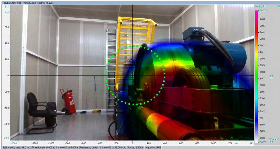
**Figura 61:** Fotografía 2D de la Acoustic Camera con el Drum girando a 40 km/h en sentido contrario, primera posición y neumático real girando.
