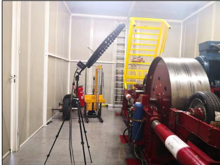
Figura 29: Fotografía de la segunda posición del array de micrófonos en el drum.
