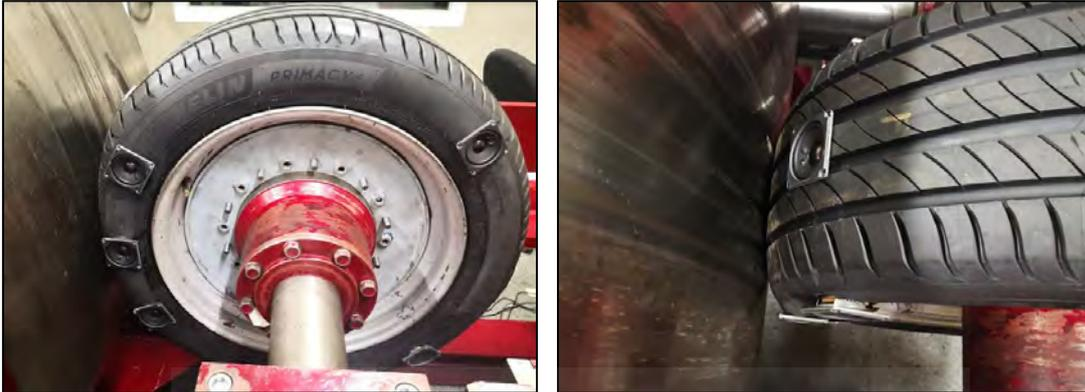
[Figura 25](#): Fuente sonora artificial montada sobre la máquina de ensayo de neumáticos.
