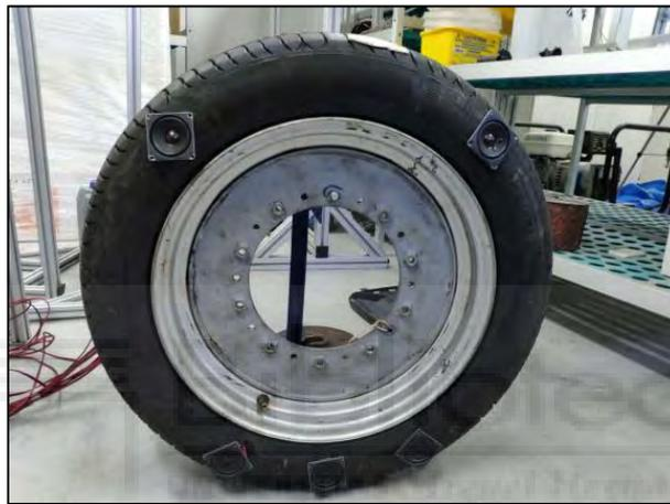
[Figura 23](#): Neumático con altavoces emisores montados.
