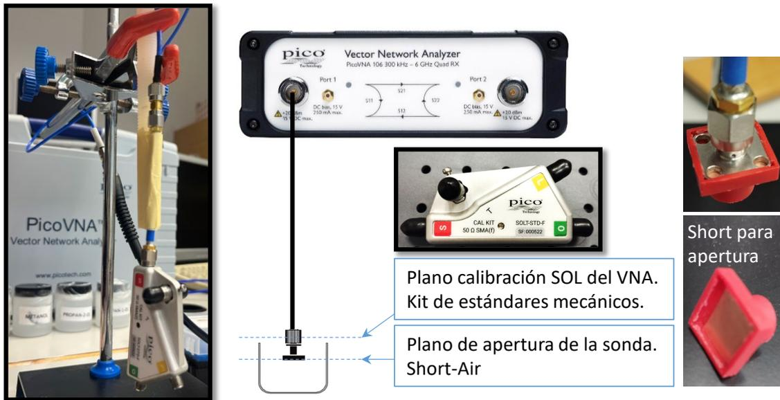
Figura 27: Calibración SOL del VNA y estándar de cortocircuito para la apertura.
