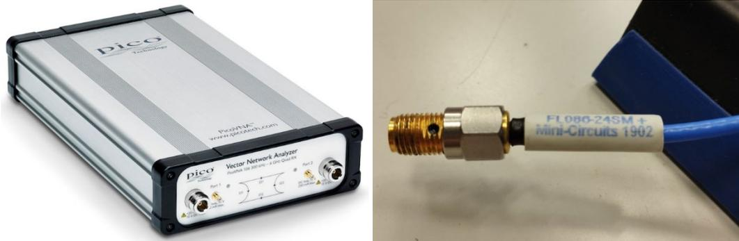
Figura 18: PicoVNA106 y extremo SMA(m) conectado a transición SMA(f)-SMA(f).
