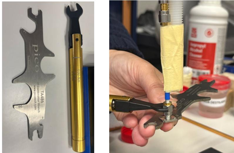
Figura 21: Llaves y ajuste de la sonda al conector del cable. Torque de 0.90 Nm
