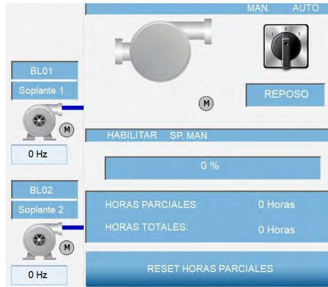
*Ilustración 32: HMI control de las bombas soplantes.*
