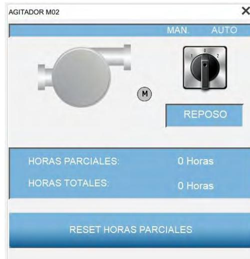
*Ilustración 35: HMI control de agitadores.*
