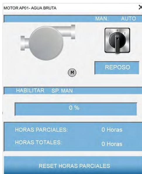
*Ilustración 29: HMI control de bombas de baja presión.*
