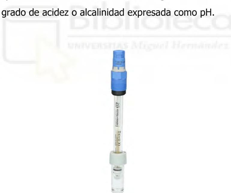
*Ilustración 18: Sensor de pH.*
