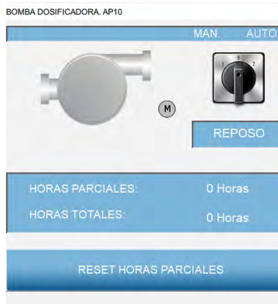
*Ilustración 36: HMI control de bombas dosificadoras.*
