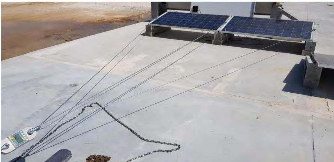
Una vez medida la altura de las sujeciones de los tirantes en los módulos, la báscula para medir los kg de tracción se coloca a la misma altura, para simular la entrada de viento a 0º, por lo que los tirantes quedan paralelos al suelo.
