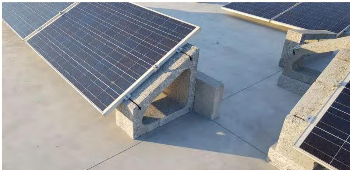
La superficie donde se ensayan las diferentes configuraciones con los módulos instalados es hormigón pulido, del que no se conoce previamente su coeficiente de rozamiento, pero una vez obtenido el valor de la fuerza necesaria para deslizar o volcar cada tipo de montaje a estudio, podemos estimar dicho coeficiente.
