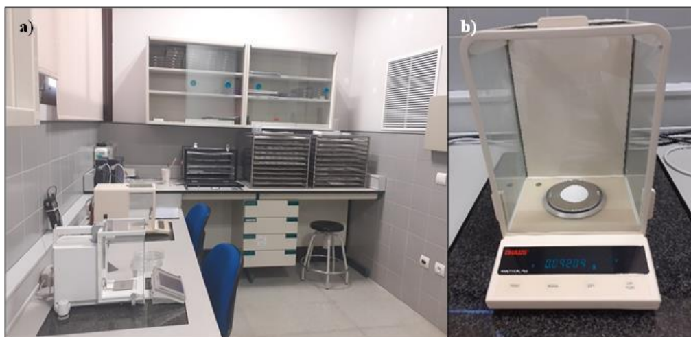
Figura 11. Sala de acondicionamiento de filtros (a) y balanza electrónica de precisión (b).
