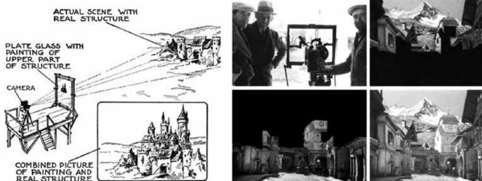
Fig. 1. Croquis realizado a mano por el propio Norman Dawn en el que se explica el funcionamiento de los *glass paintings*. A la derecha puede apreciarse el cristal montado delante de la cámara, el elemento pintado (arriba), el elemento real y la composición resultante (abajo).
