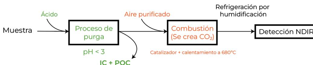
Figura 6. Diagrama esquemático de la medición de NPOC, donde IC: carbono inorgánico, POC: carbono orgánico purgable.
