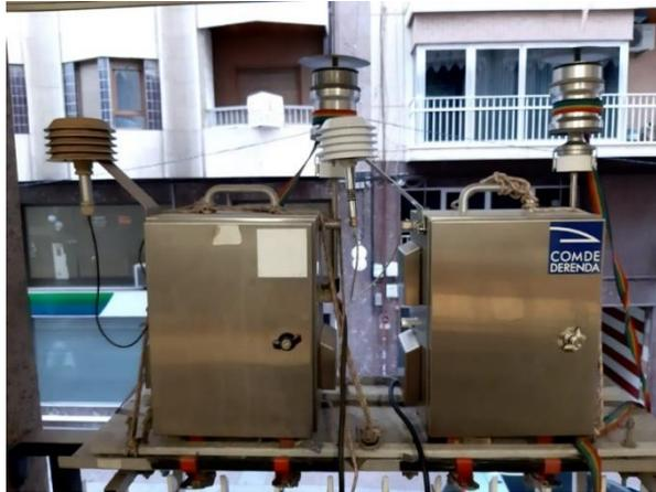
Figura 3. Captadores de PM<sub>1</sub> y PM<sub>10</sub> empleados en el lugar de muestreo.
