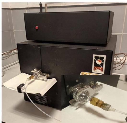
Figura 4. Analizador termo-óptico de transmisión Sunset.
