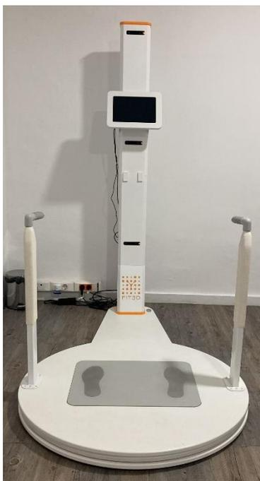
*Imagen 3 - Escáner 3D de la marca FIT3D, modelo ProScanner 4.0*
