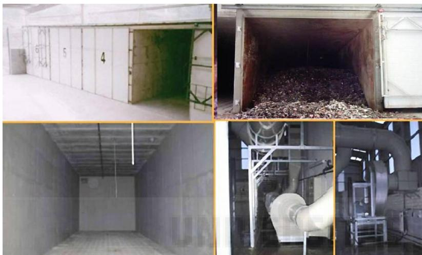
**Figura 31.** Túneles de compostaje. Tomado de Chica Pérez et al. (2015).
