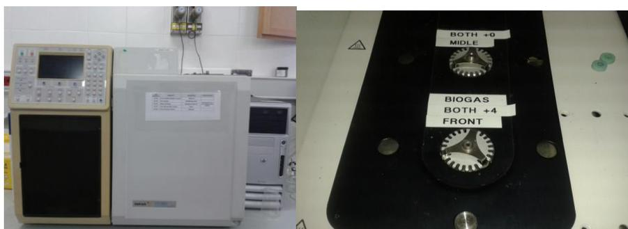
Figura 5 Cromatógrafo de gases VARIAN CP-3800
