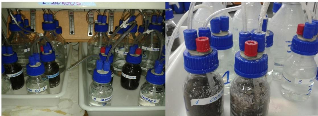
Figura 14 Ensayo 2: montaje e incidencia en el seguimiento (cristalización de sosa)
