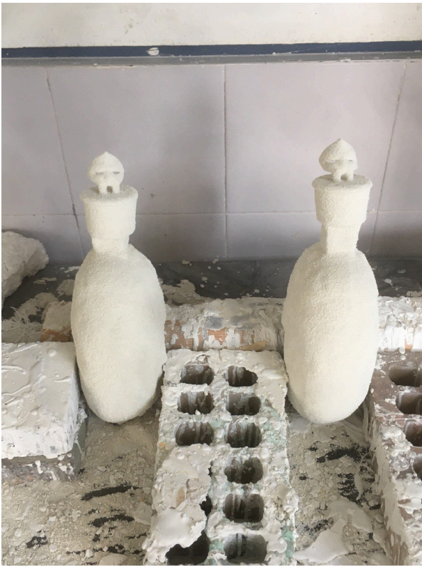
Fig. 6 Proceso de elaboración de la cascarilla cerámica
