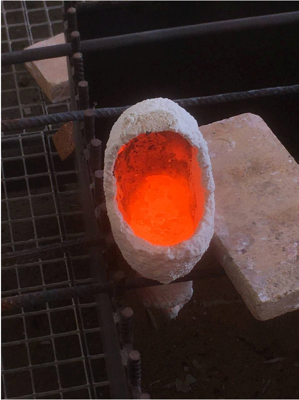
Fig. 14 Proceso de colada
