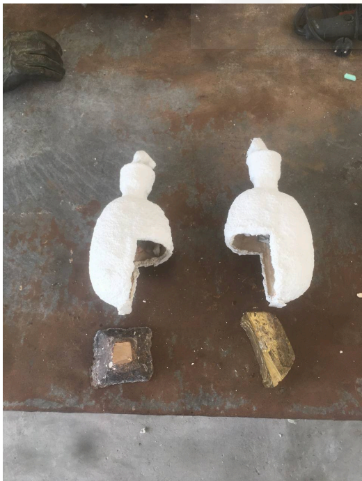
Fig. 12 Ambos moldes válidos listos para la colada. Derecha con bronce, izquierda latón
