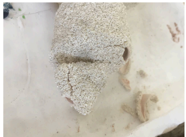
Fig. 9 Molde roto no apto para reparación
