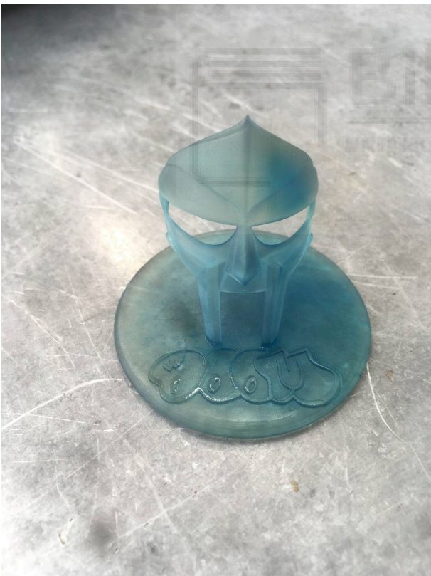
Fig. 4 Pieza impresa (resina blue cast)
