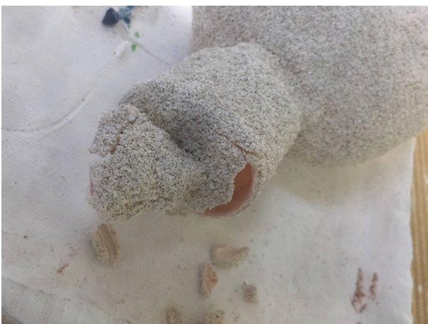
Fig. 8 Molde roto no apto para reparación
