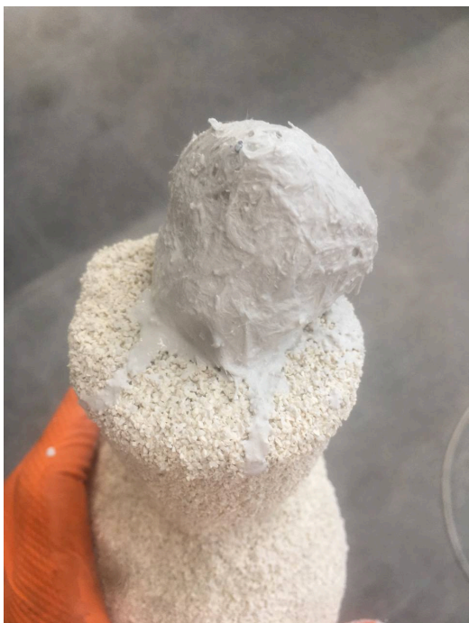
Fig. 11 Grieta reparada con fibra
