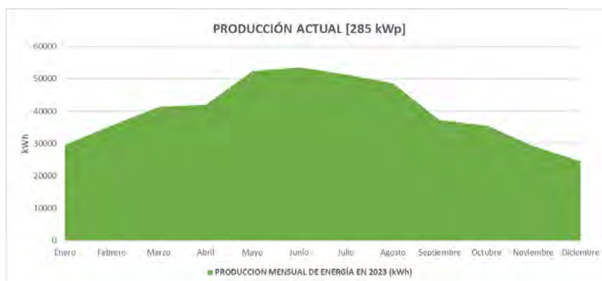
Figura 77. Producción actual [285 kWp]
