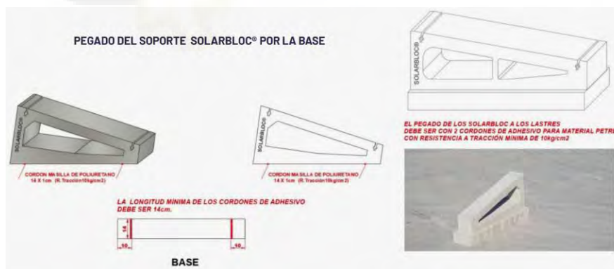
Figura 14. Pegado del soporte al lastre. Fuente: www.solarbloc.es
