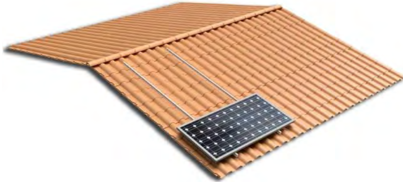
Figura 1.2.18. Colocación de perfiles perpendiculares a la cumbrera
