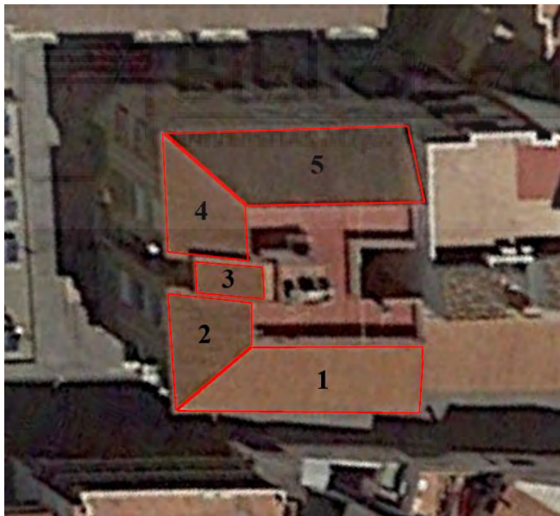
Figura 1.2.2. Superficies disponibles para la instalación de módulos FV
