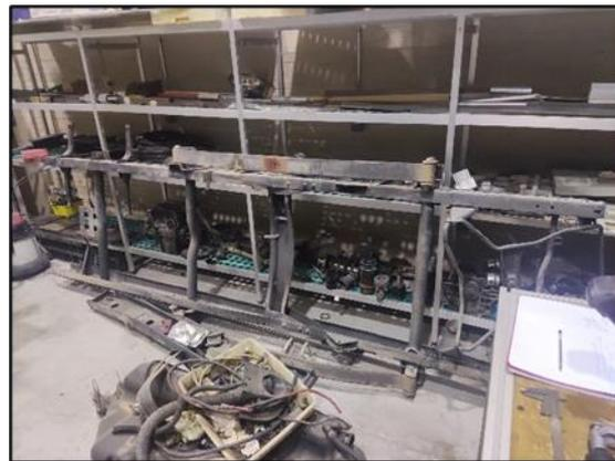
Ilustración 18: Chasis del camión base.
