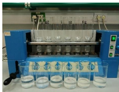
Figura 26. Equipo de filtración CFS
