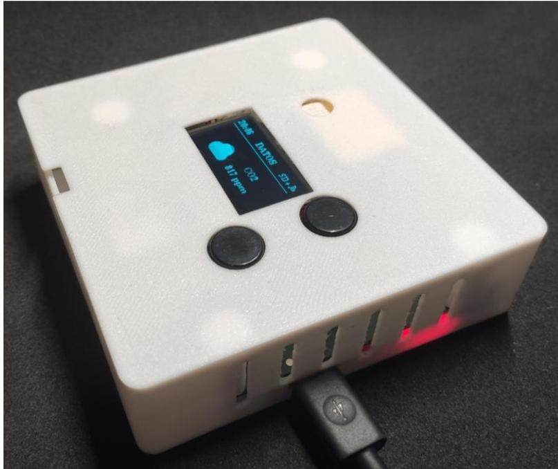
*Figura 98 – Carcasa fabricada – Destacan los orificios practicados para la ventilación y para la toma de muestra de los sensores.*
