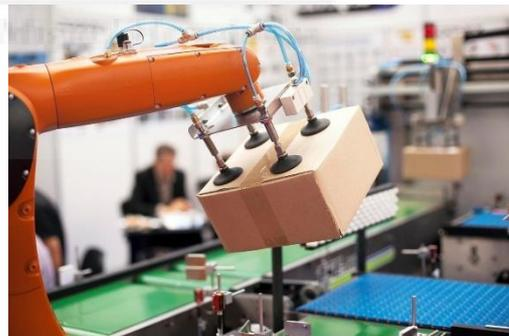
Figura 1. Pinza de vacío
