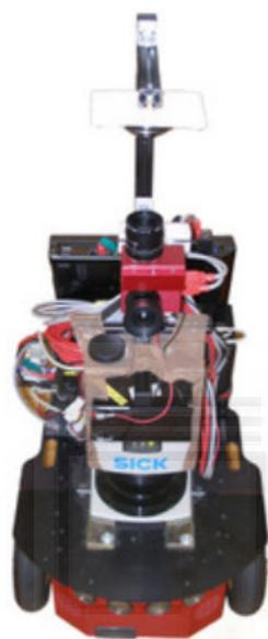
**Figura 3-4:** Ejemplo de robot móvil autónomo ActivMedia Pioneer-3.
