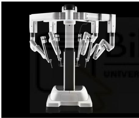
**Figura 1-1:** Robot quirúrgico Da Vinci diseñado por Intuitive Surgical <https://www.intuitive.com/en-us>.
