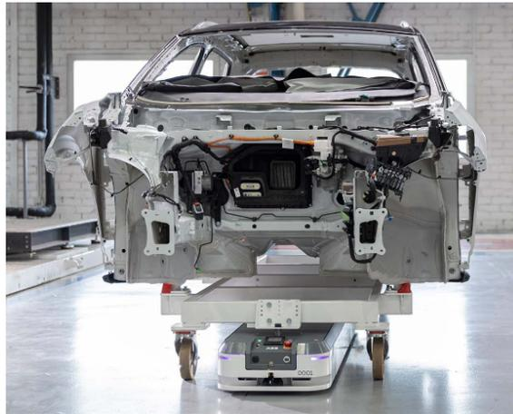
**Figura 1-3:** Robot móvil autónomo Flexley Tug de ABB empleado para el transporte de piezas de vehículos en una industria <https://new.abb.com/es>.
