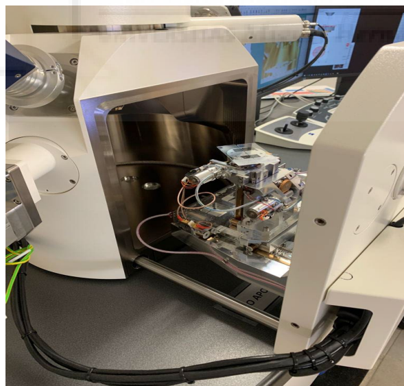
Figura 5 Interior del microscopio electrónico de barrido de emisión de campo (FESEM) SIGMA 300 VP.
