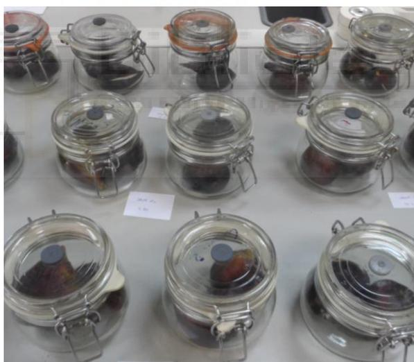
**Figura 6.** Recipientes herméticamente cerrados usados para determinar tasa de respiración y producción de etileno. Fuente: Elaboración propia, 2018.
