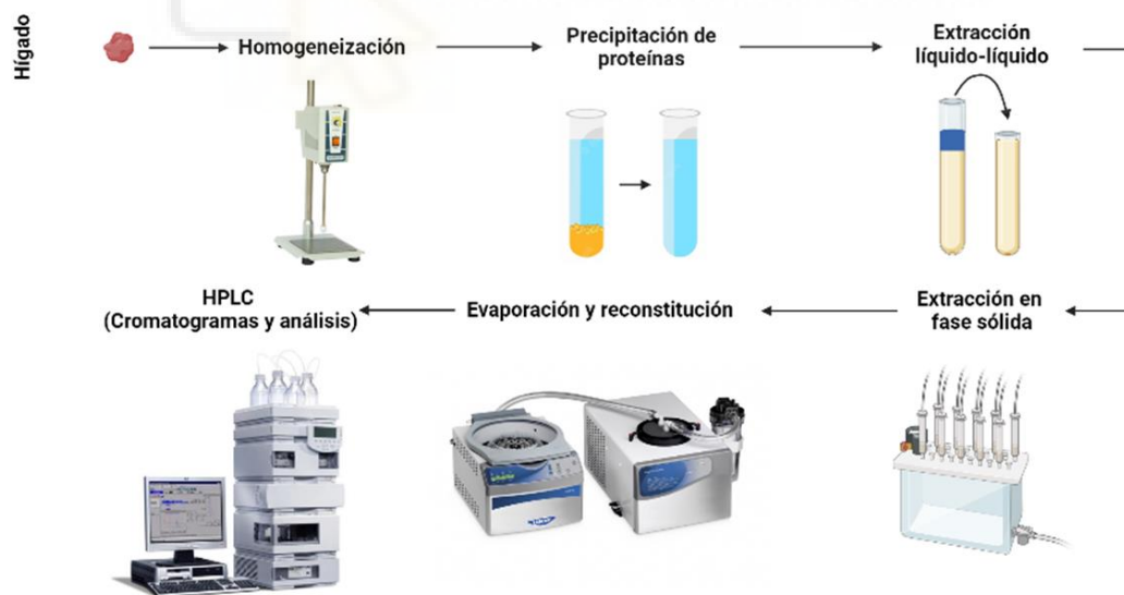
Figura 10. Protocolo del procesado de las muestras, análisis mediante HPLC y programas de cromatografía
