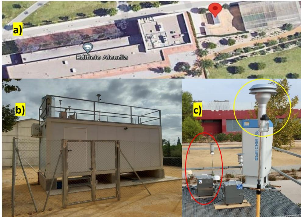
Figura 8: Ubicación del punto de muestreo dentro del campus de la Universidad Miguel Hernández (UMH) (a). Foto extraída de Google Maps; Cabina de monitorización de contaminación atmosférica (b). Foto hecha por Jorge Seva Jara; y equipos de muestreo (c): captador de bajo volumen (rojo) y cabezal del etalómetro (amarillo). Foto hecha por Jorge Seva.
