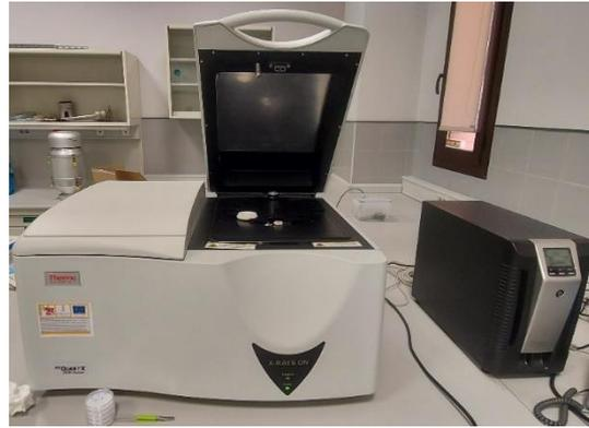
Figura 9: Espectrómetro ARL Quant'X (Thermo Fisher Scientific Inc, USA). Fotografía hecha por Jorge Seva Jara.
