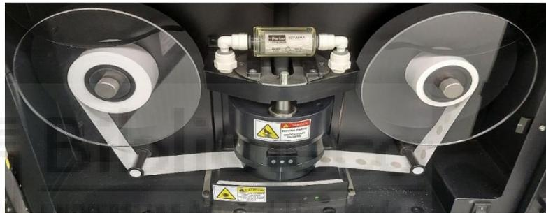
Figura 14: Etalómetro AE33 por dentro donde se muestran sus partes y la cinta con la toma de muestra. Fotografía hecha por Jorge Seva Jara.
