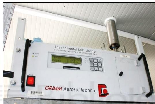
**Figura 10.** Contador óptico GRIMM modelo 190.
