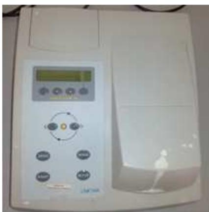
**Figura 3.7.** Espectrofotómetro spectronic. Modelo Helios epsilon
