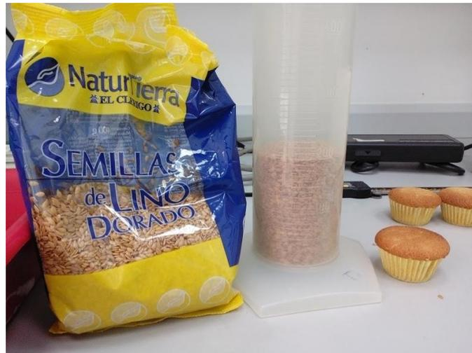
Figura 16: Semillas de lino y probeta utilizadas para la medición de volumen y densidad.
