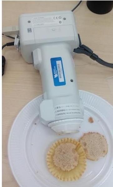
Figura 17: Espectrofotómetro Minolta Camera CM 700-D.
