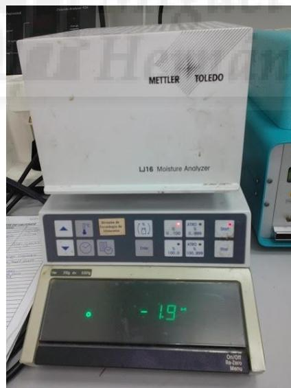
Figura 21: Balanza de desecación por infrarrojos.
