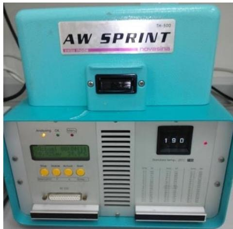
Figura 20: Higrómetro Novasina.
