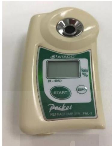
*Figura 23. Refractómetro.*
