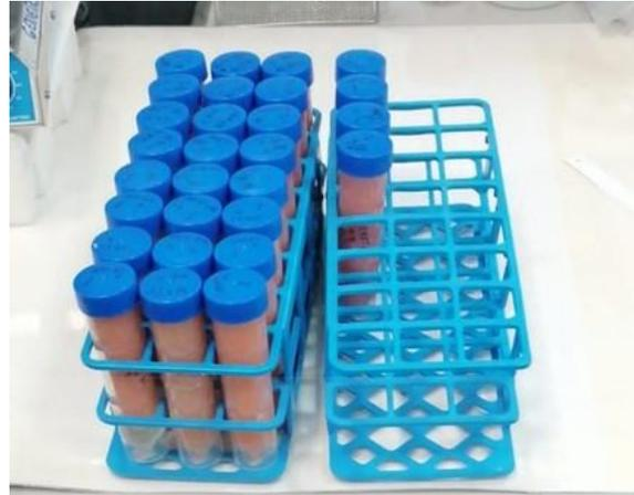
*Figura 21. Tubos con las muestras trituradas, que se conservan a  $-18^{\circ}\text{C}$  hasta su análisis.*
