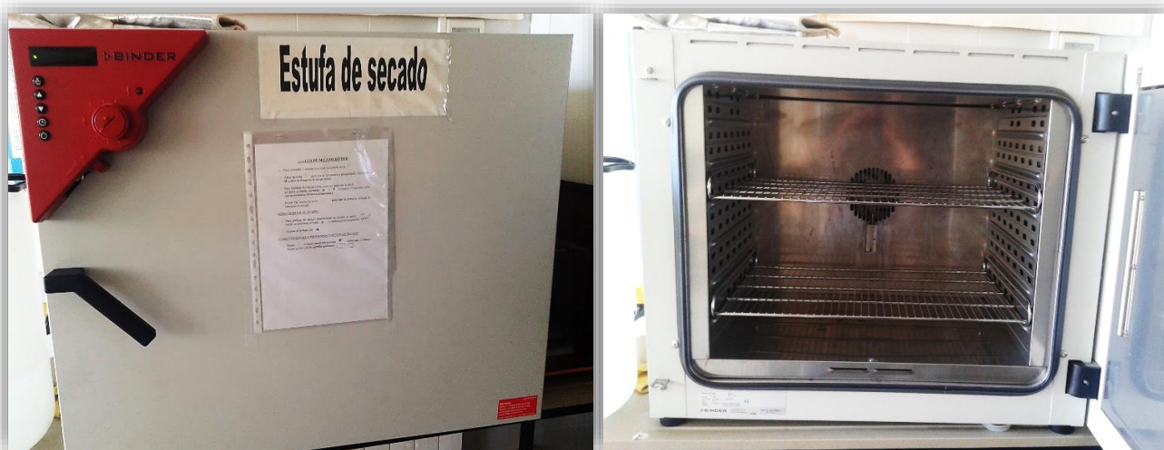
Figura N° 6. Estufa de secado con aire caliente utilizada en la deshidratación de los frutos rojos. Fuente: Elaboración propia.
