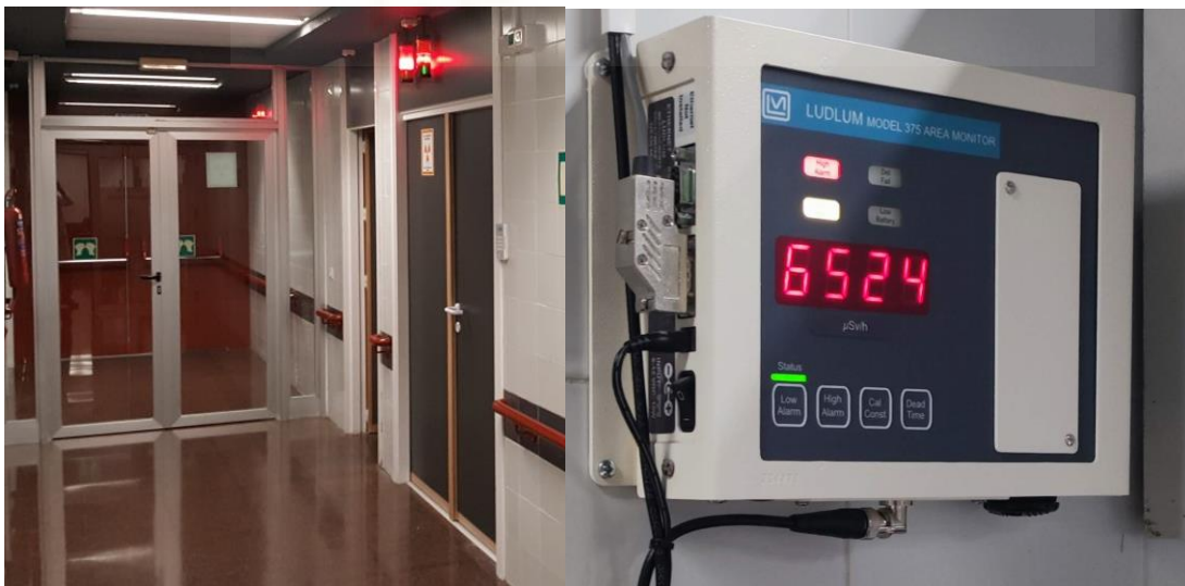
Figura 16. Señal luminosa roja y panel con nivel elevado, indican que existe radiación en estos momentos.
