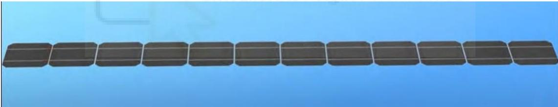
Ilustración 4: Conexión en serie células fotovoltaicas
