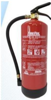
**BOTELLA:** De acero de alta calidad DC04 DC01 EN 10130:2006 conformada por embutición profunda, soldadura MIG , casquillo roscado soldado y, presilla soldada por puntos. Fondo con tetones. En el 100 % de botellas ha sido probada su estanqueidad y ausencia de fugas.
