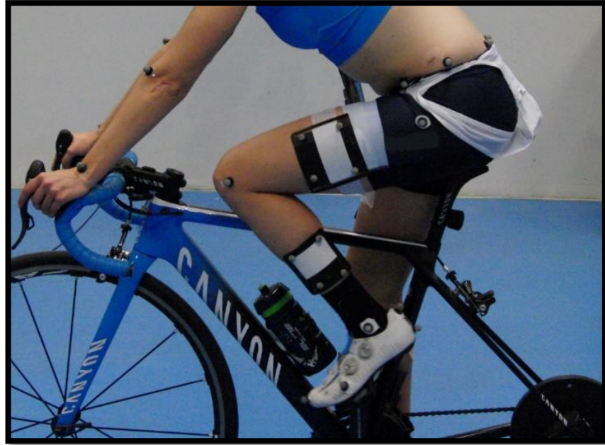
Figura 3.2. Placas rígidas con 4 marcadores solidarios ( clusters ) colocadas en la parte exterior del muslo y de la pierna para facilitar el seguimiento de los marcadores internos de rodilla y tobillo.
