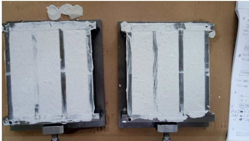
FOTOGRAFÍA 23: PROBETAS EN EL MOLDE (FUENTE: LABORATORIO DE CONSTRUCCIÓN DE LA EPSO)
