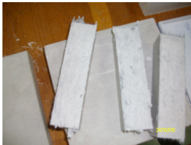
FOTOGRAFÍA 24: PROBETAS DESMOLDADAS (FUENTE: LABORATORIO DE CONSTRUCCIÓN DE LA EPSO)
