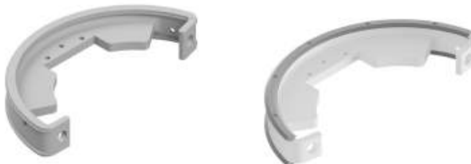
Figura 5.5: Modificaciones en la polea de salida (a la izquierda se observa la pieza del prototipo anterior, mientras que a la derecha se observa la nueva versión). Se ha modificado el perfil de la parte deslizante de la polea de salida y se ha dividido en dos piezas para facilitar su fabricación.
