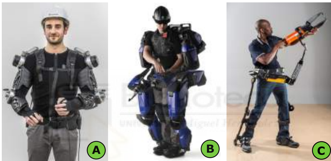
Figura 2.2: Ejemplos de exoesqueletos activos que dan soporte al miembro superior. A - Stuttgart Exo-Jacket (Fuente: Fraunhofer IPA), B - Guardian®XO®(Fuente: SARCOS) y C - FORTIS Exiskeleton (Fuente: Lockheed Martin).
