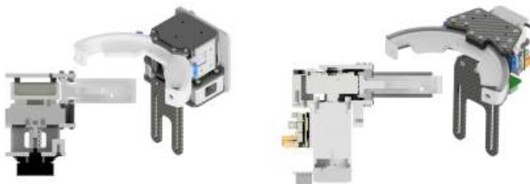
Figura 5.1: Nueva configuración de la articulación rI/E .
