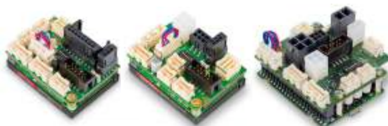
Figura 5.2: Electrónicas empleadas para controlar los actuadores del sistema robótico (EPOS4, Maxon Motor®)
