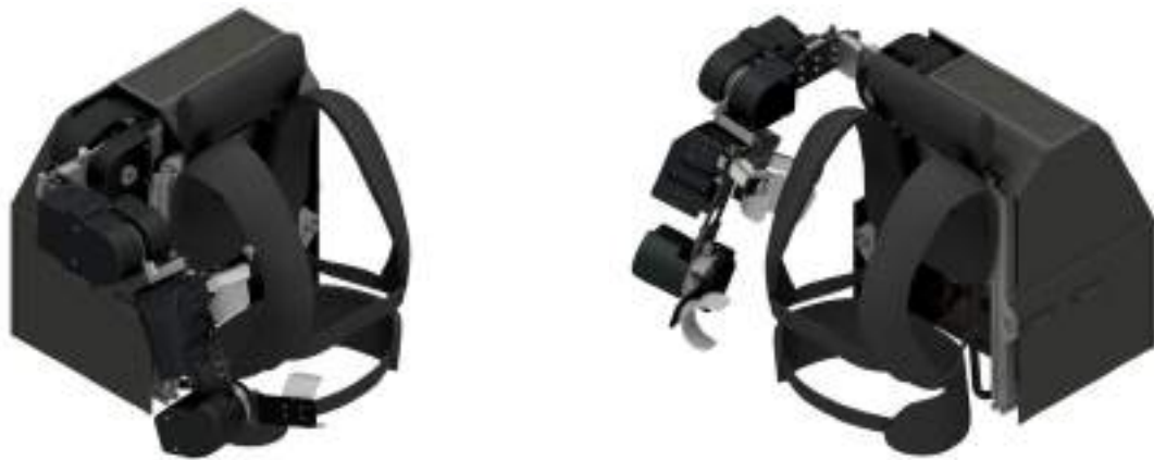
Figura 5.8: Diseño del nuevo exoesqueleto de miembro superior.
