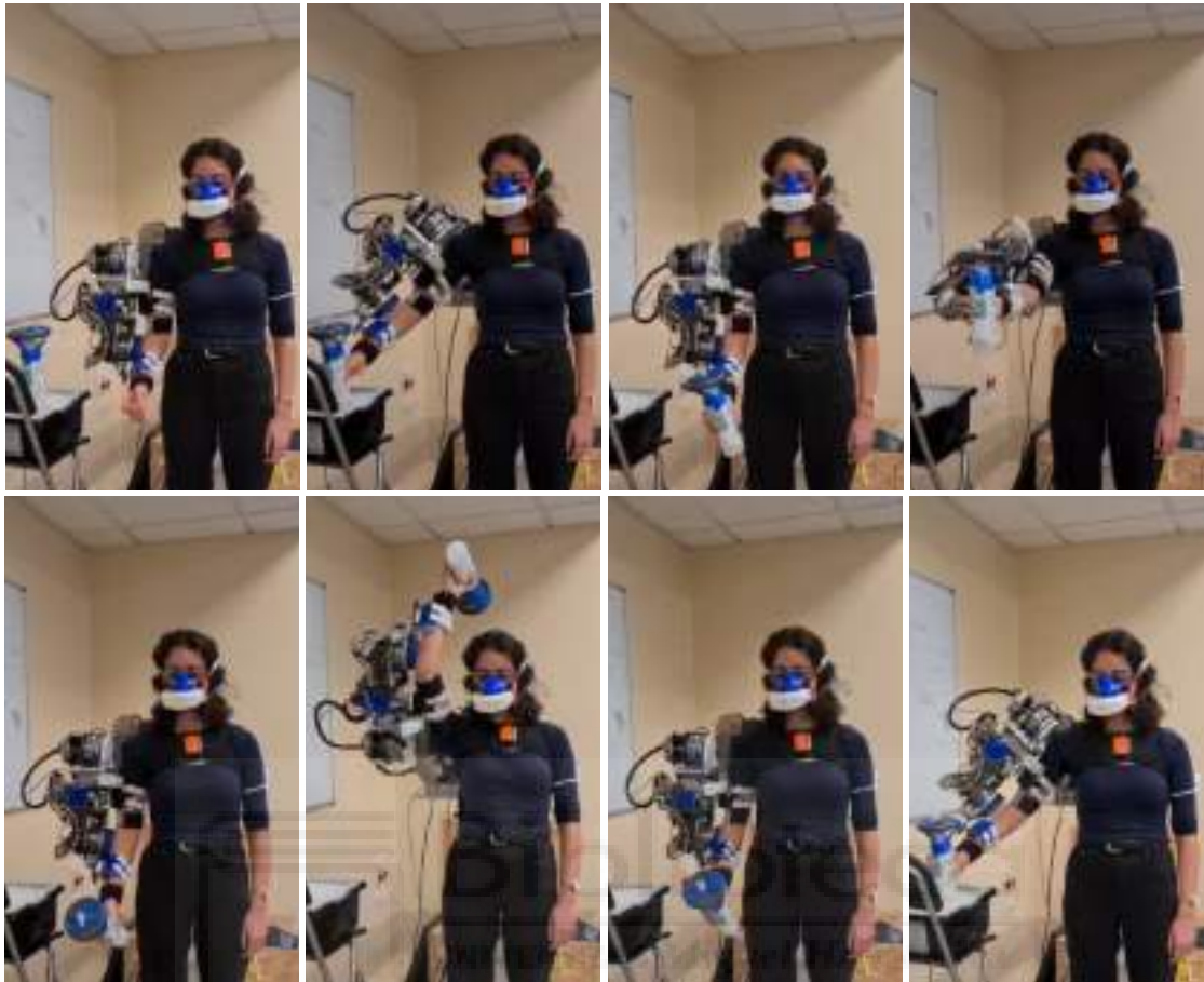
Figura 6.15: Grabación de la trayectoria con el exoesqueleto para llevar a cabo la tarea completa.
