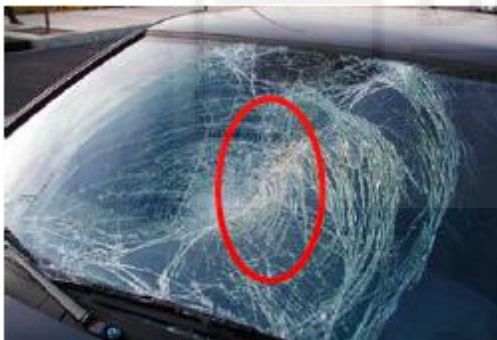
Rotura de luna delantera por impacto de persona.
