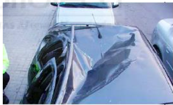
Abolladura en techo por impacto lateral.
