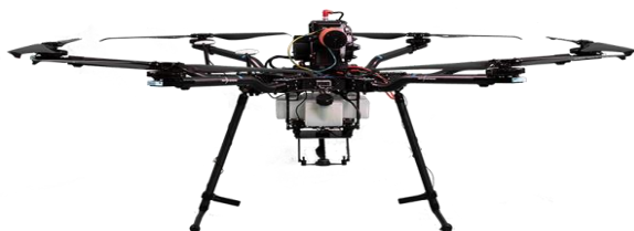
Figura 1.8. UAV/hibrido de la empresa Aerocámaras.
